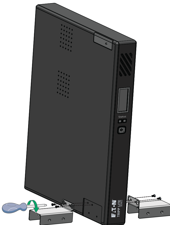
Figure 5. Montage en position tour
